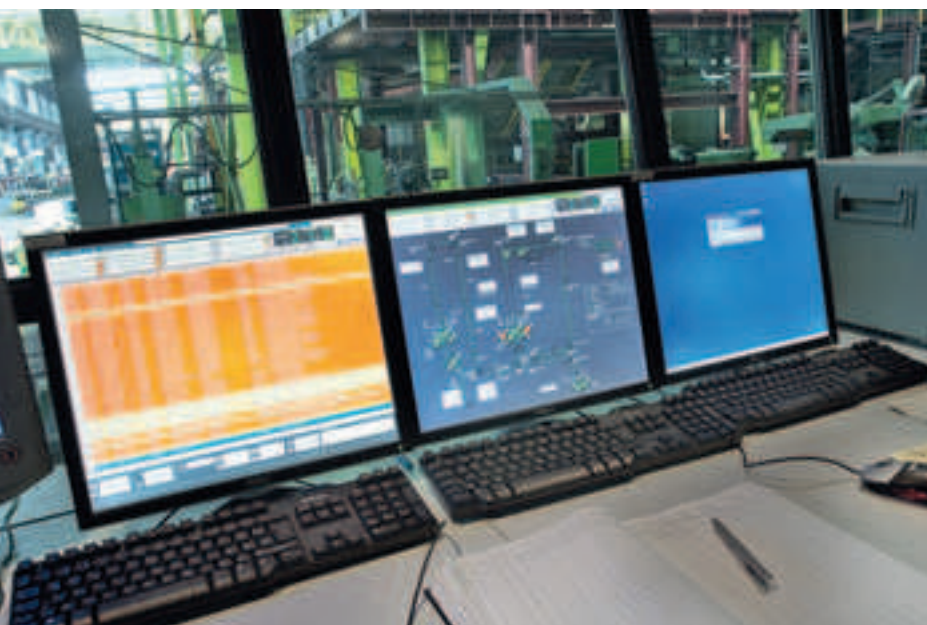
Maximale Prozesstransparenz und komfortables Bedienen und Beobachten realisiert ein redundantes SCADA-System auf der Basis von WinCC
